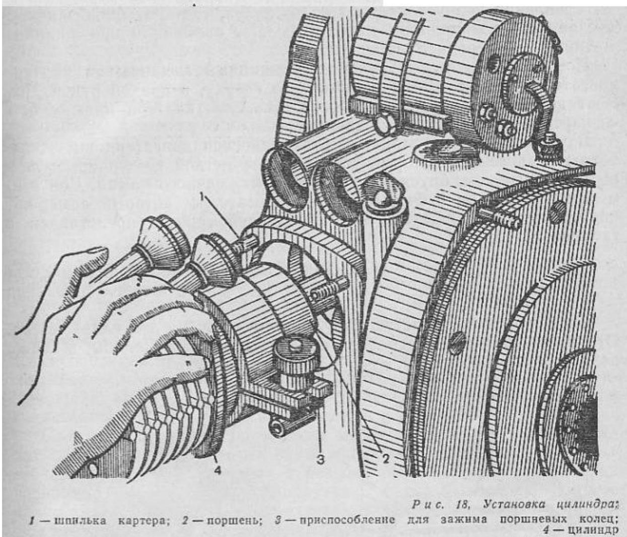
Для монтажа цилиндров двигателей мотоциклов серии «Урал» и «Днепр» (рис. 18) кривошипный механизм устанавливают аналогично положению при снятии цилиндра. Поршень и поршневые кольца смазывают маслом для двигателя. Укладывают прокладку цилиндра. При установке левого цилиндра три масляных отверстия в прокладке должны совпадать с отверстиями цилиндра и картера двигателя. Перед установкой цилиндра на место замки поршневых колец разводят под углом 120°.
