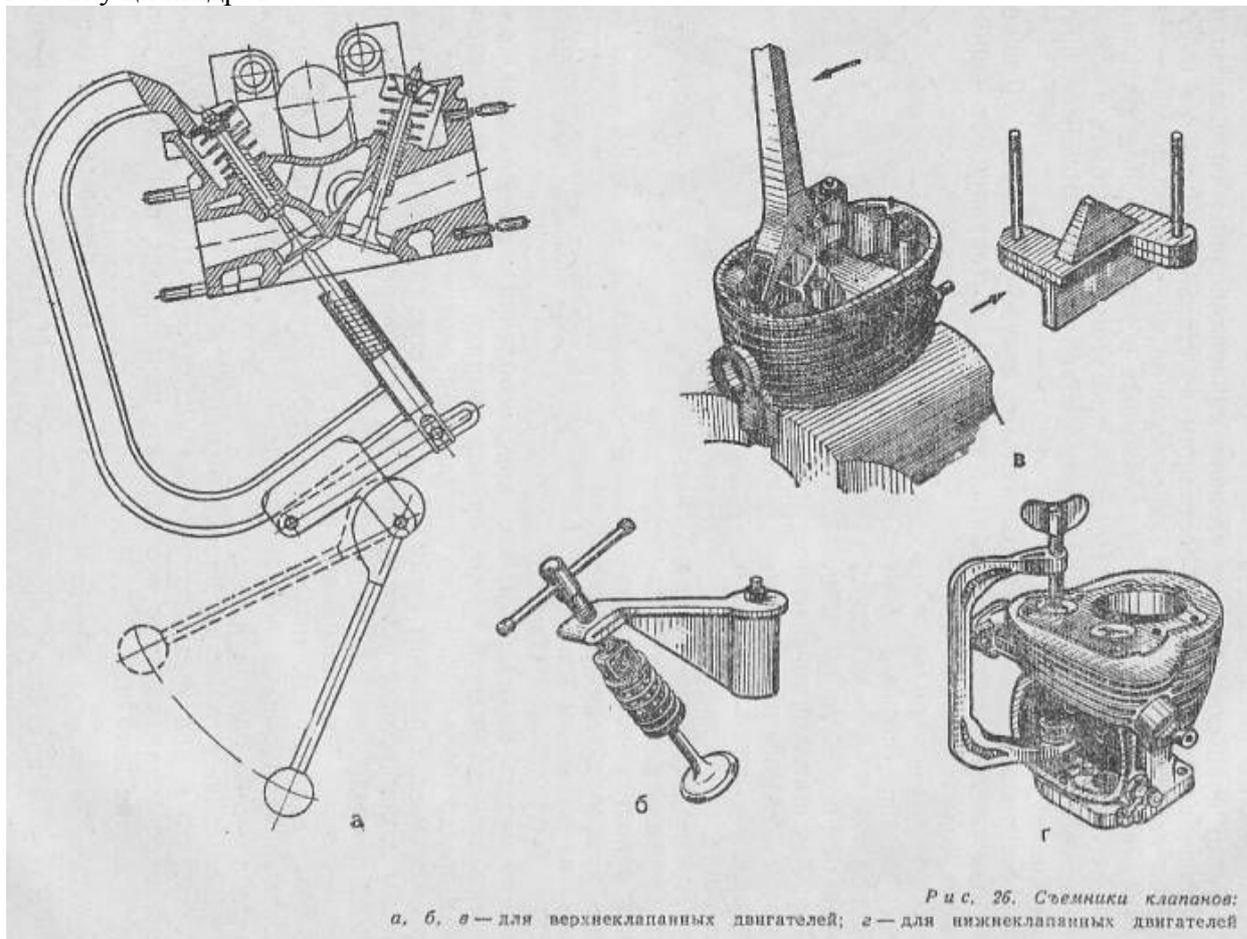
Клапаны демонтируют с помощью съемников (рис. 26), значительно упрощающих операции по извлечению и установке клапанов. Если их нет, клапаны извлекают следующим образом: устанавливают головку с клапанами на деревянную опору, к подпятнику пружины прикладывают отрезок металлической трубки с отверстием, достаточным для выхода сухариков, и слегка ударяют молотком по торцу трубки, сухарики выходят из своего гнезда от одного-двух ударов.
