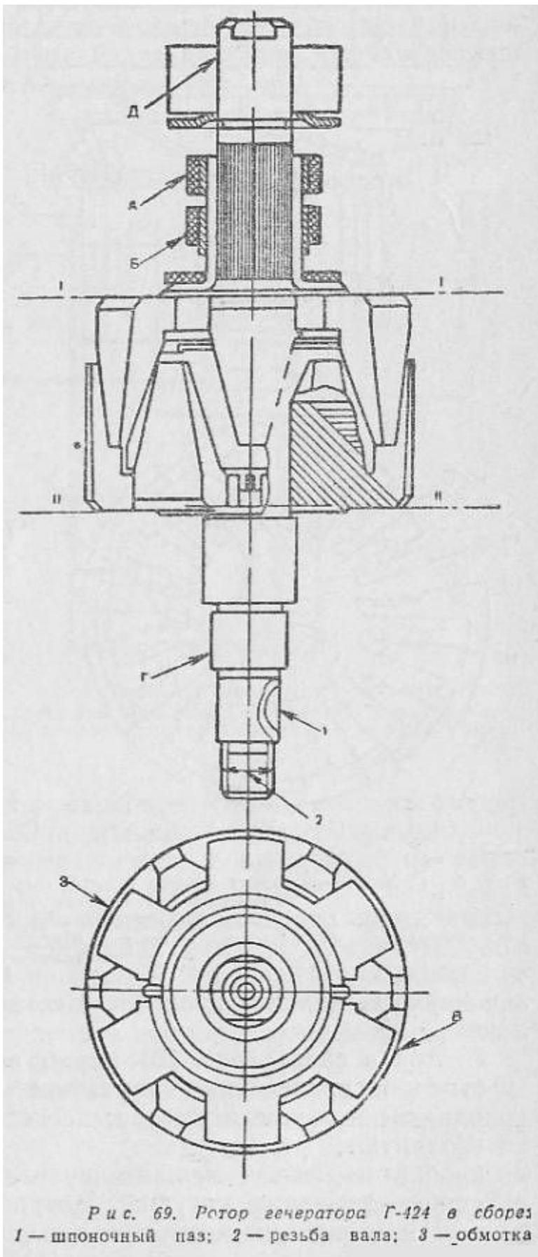
Рис. 69. Ротор генератора Г-424 в сборе:
