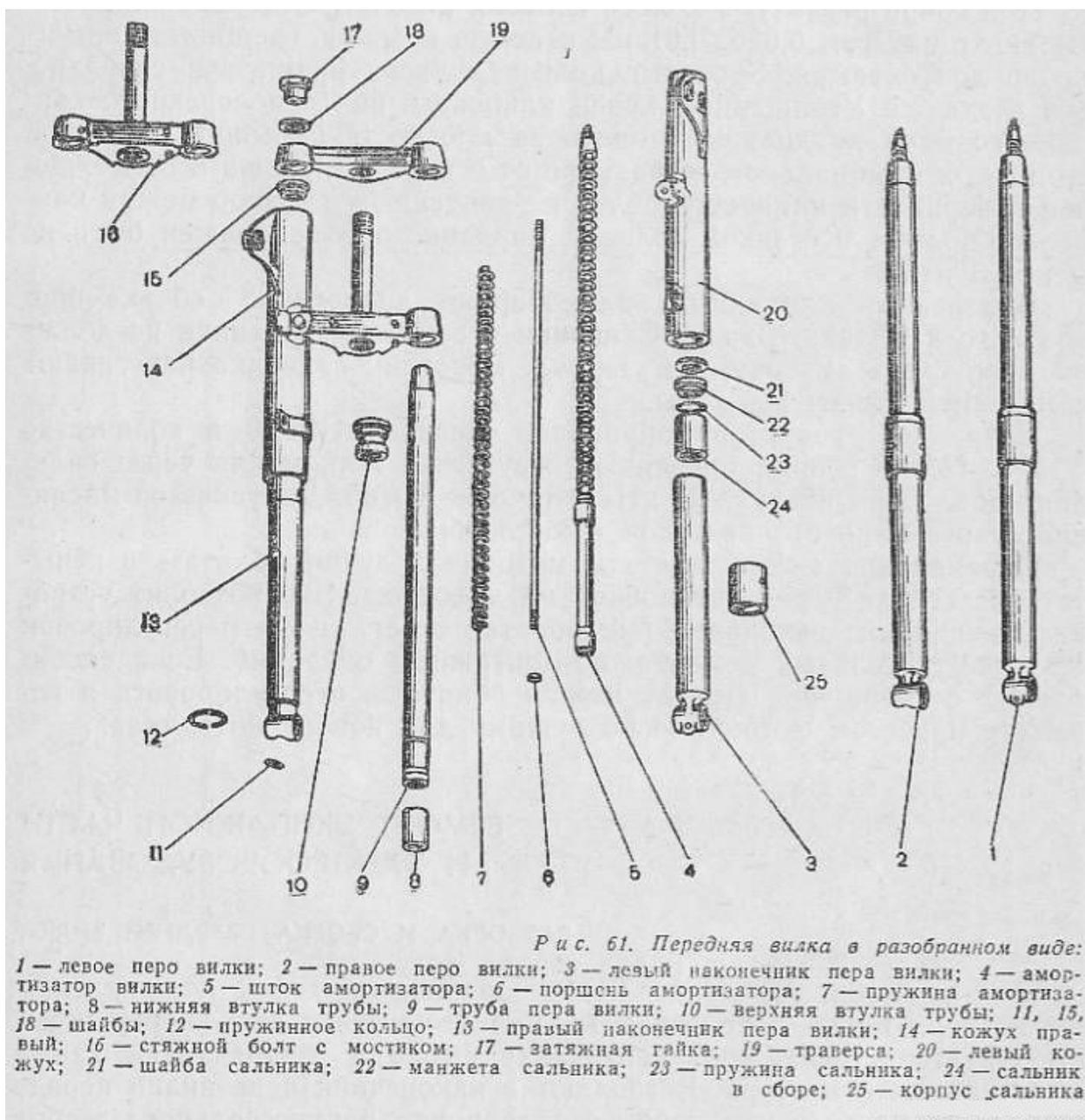
Для разборки амортизатора отворачивают внизу наконечника пера вилки болт крепления конуса корпуса амортизатора 4, снимают шайбу 15 амортизатора и уплотнительную шайбу 18 под болтом, вынимают амортизатор 4 в сборе с пружиной, сворачивают верхнюю гайку на штоке амортизатора и пружины и верхний наконечник. Затем снимают пружину, отворачивают гайку трубки амортизатора и вынимают шток 5.
