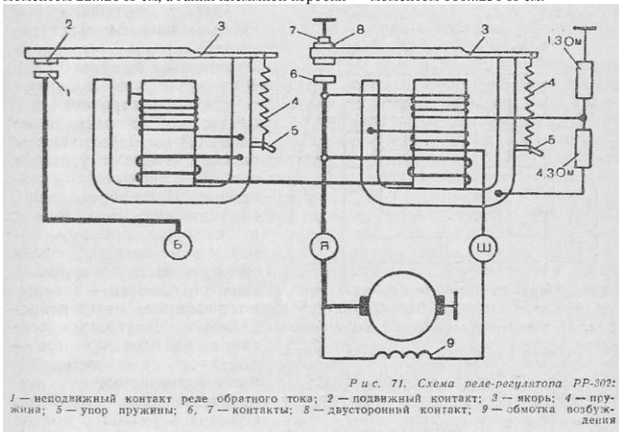
**Реле-регулятор РР-302.** Реле-регулятор состоит из реле обратного тока (РОТ), регулятора напряжения (РН) и ограничителя тока. Он работает, когда якорь генератора вращается с малой частотой вращения, контакты 1 и 2 (рис. 71) разомкнуты, а двусторонний контакт 8 якорька регулятора прижат пружиной к верхнему контакту 7, соединенному с «массой». В этом положении обмотка возбуждения 9 генератора соединяется с «массой» через компенсационную обмотку и контакты 8 и 7 регулятора.
