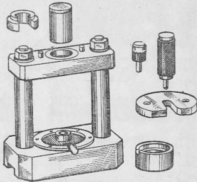
51. Приспособление с оправкой для сборки и разборки шестерен газораспределения и ведущего вала коробки передач
