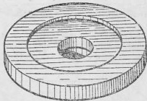
22. Кольцо к оправке для снятия переднего корпуса из картера двигателя
