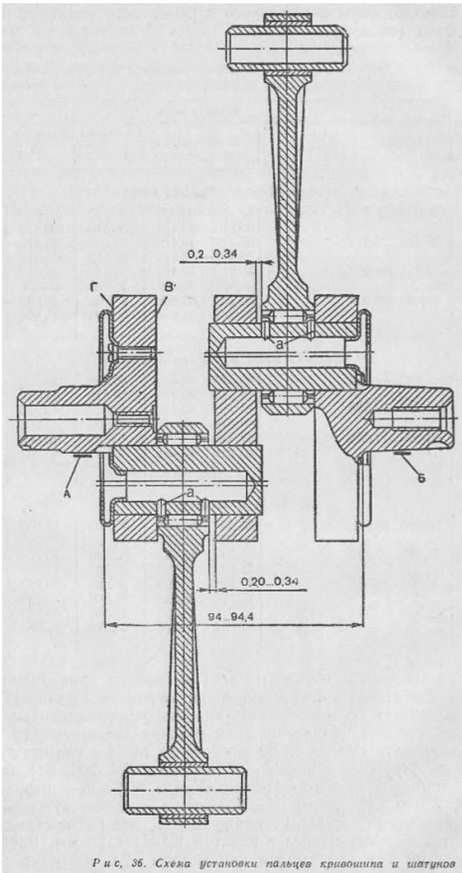
Р и с. 36. Схема установки пальцев кривошипа и шатунов
