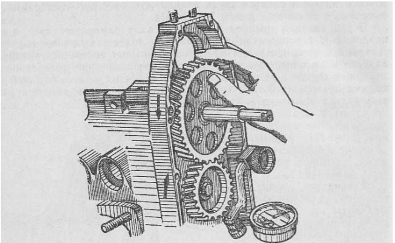
Рис. 32. Замер торцового биения зубчатых колес распределения
