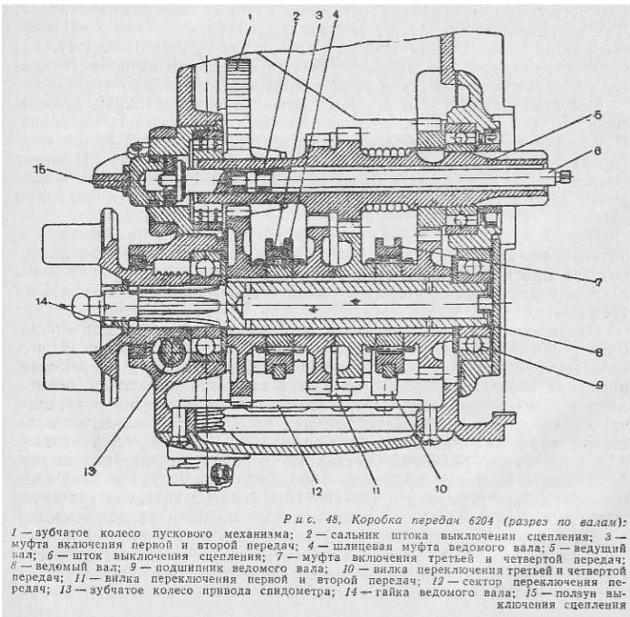
Механизм коробки передач 6204 собран в литом неразъемном картере с тремя съемными крышками: передней, служащей опорой для подшипников, и двумя боковыми — правой и левой. Основные части коробки передач (разрез по валам) показаны на рисунке 48.
