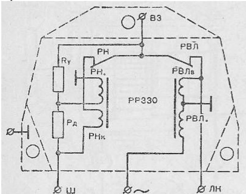
Рис. 72. Электрическая схема реле-регулятора РР-330:
