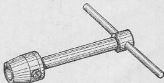
8. Съемник толкателя с направляющей из картера двигателя
