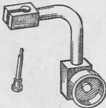
12. Приспособление для проверки бокового зазора между зубьями шестерен привода газораспределения
