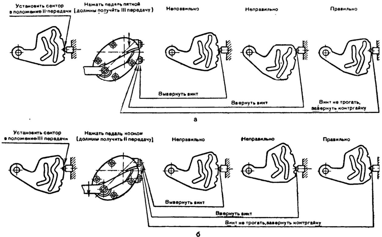
Рис. 57. Схема регулировки механизма переключения передач: а — нижнего упора; б — верхнего упора
