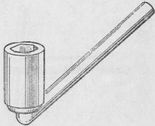
15. Торцовый ключ 36-мм для отвертывания и затяжки болта маховика
