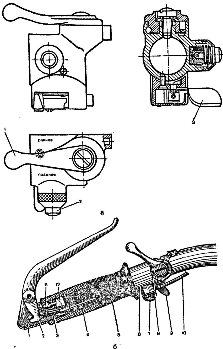
Рис. 11. Комбинированный переключатель П-45 с левой частью руля:
