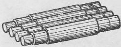
28. Набор оправок для проверки коленчатого вала «по треугольнику»
