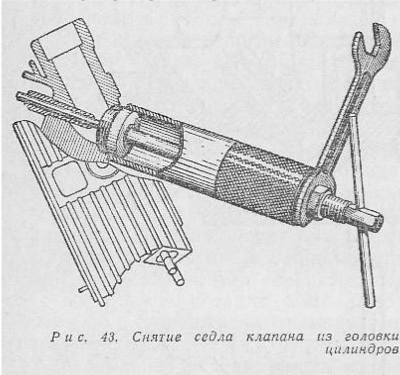
Р и с. 43. Снятие седла клапана из головки цилиндров
