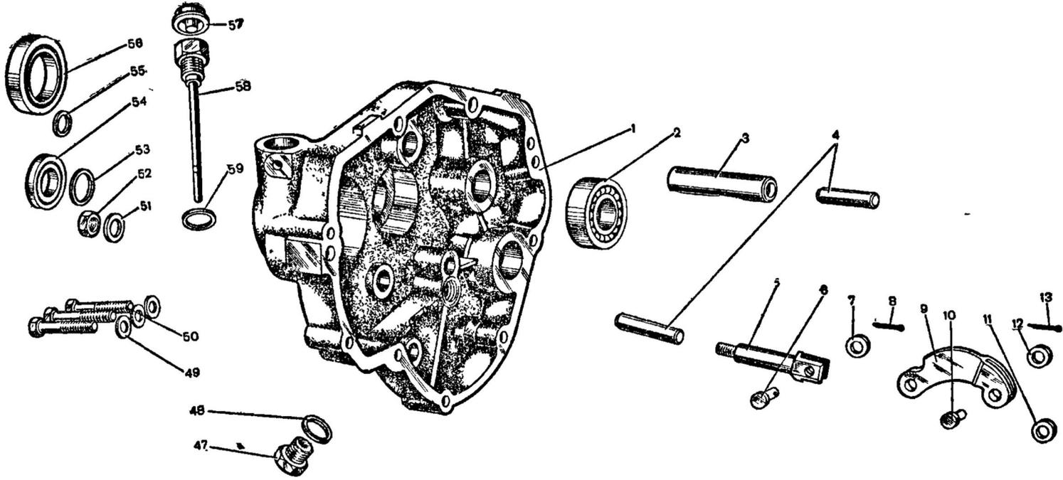
Извлекают из картера (рис. 55) штифт 29, снимают рукоятку включения заднего хода 17 и вынимают из картера рычаг включения задней передачи 31.
