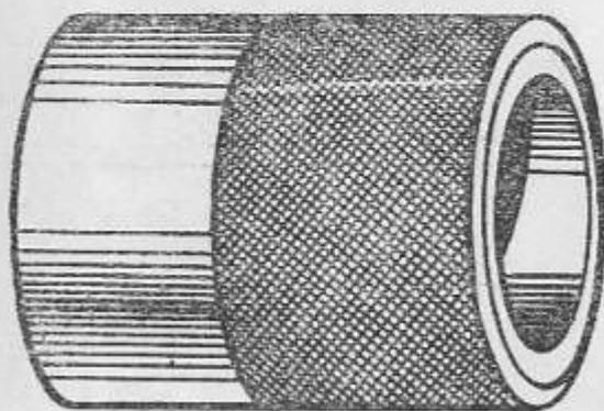
67. Оправка для установки воротникового сальника задней передачи
