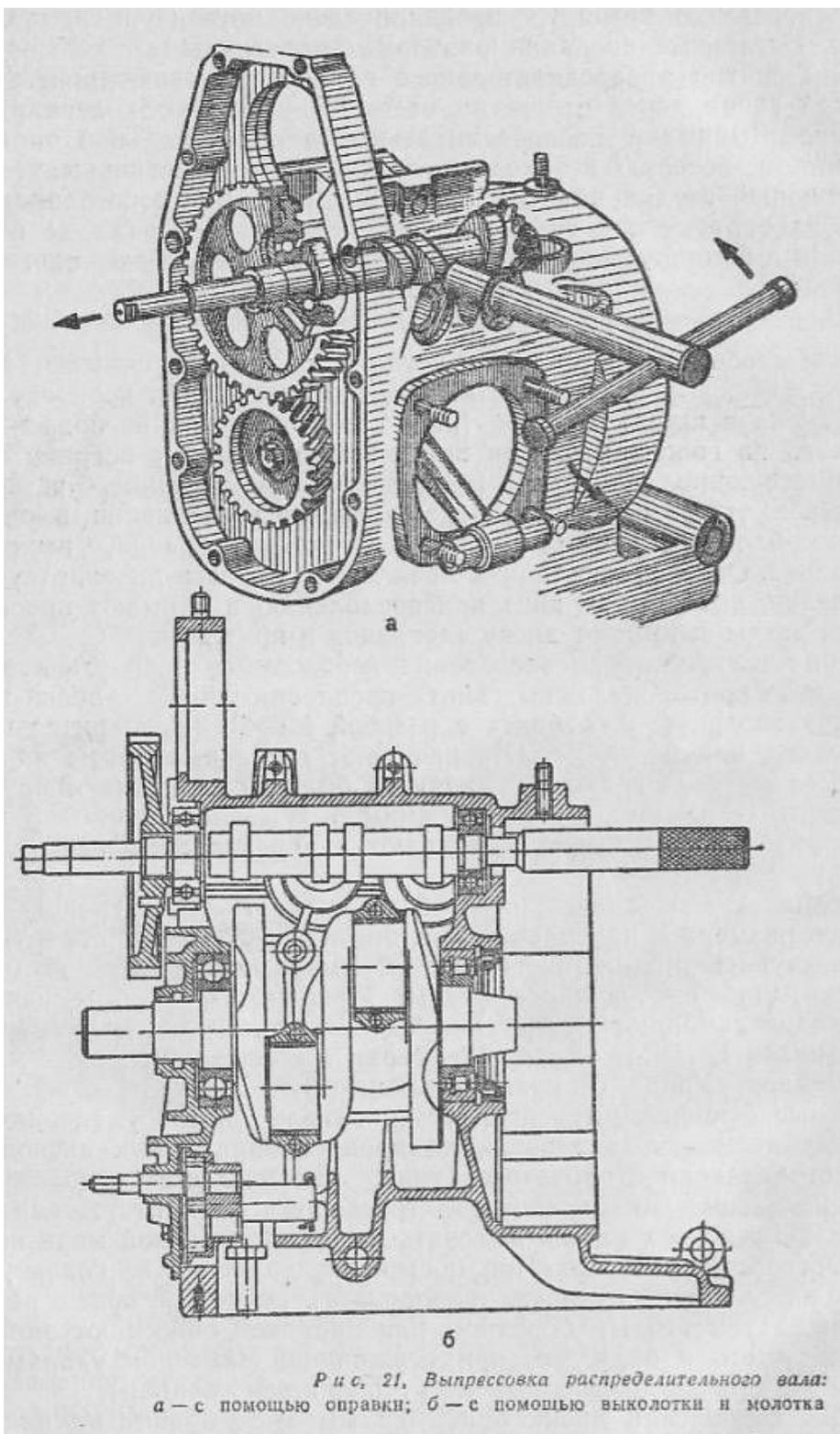
Рис. 21. Выпрессовка распределительного вала:
