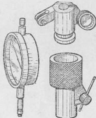
45. Приспособление для проверки concentричности фаски седла клапана
