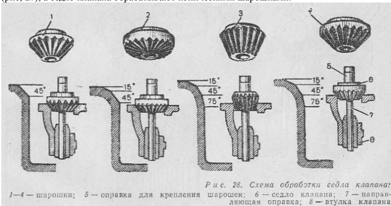
Обработку седла начинают шарошкой с углом 45', затем срезают верхний поясек седла шарошкой с углом 15', после чего шарошкой с углом 75' снимают фаску в нижней части седла (рис. 28) или шлифованием рабочей поверхности седла абразивными кругами с углами 45, 15 и 75' с помощью ручной дрели.
