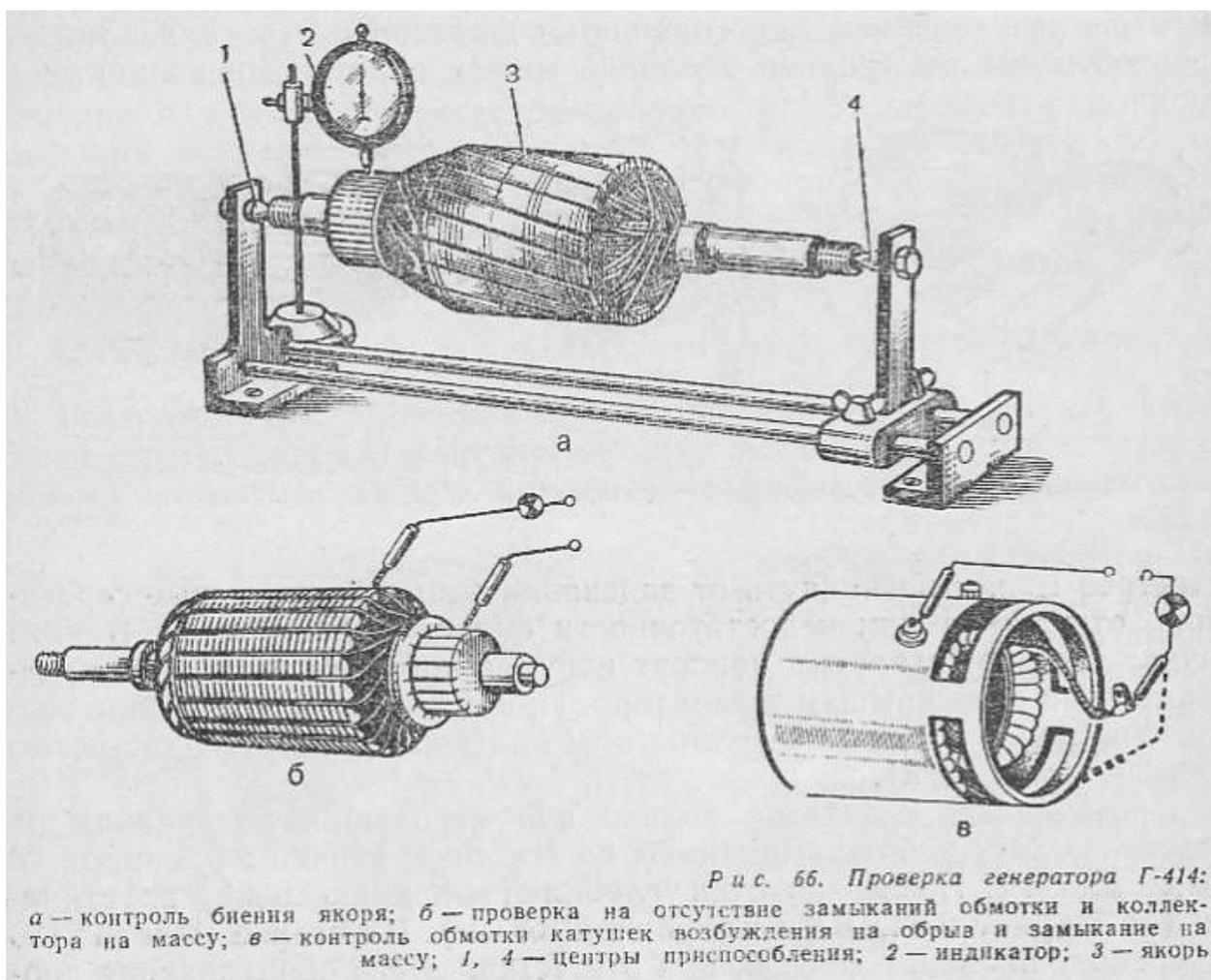
Биение якоря определяют в центрах индикатором (рис. 66). Суммарное биение якоря не должно превышать 0,05 мм. В случае повышенного биения якорь правят на призмах.
