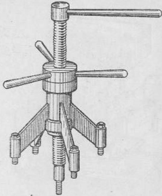
24. Приспособление для втягивания коленчатого вала в передний подшипник
