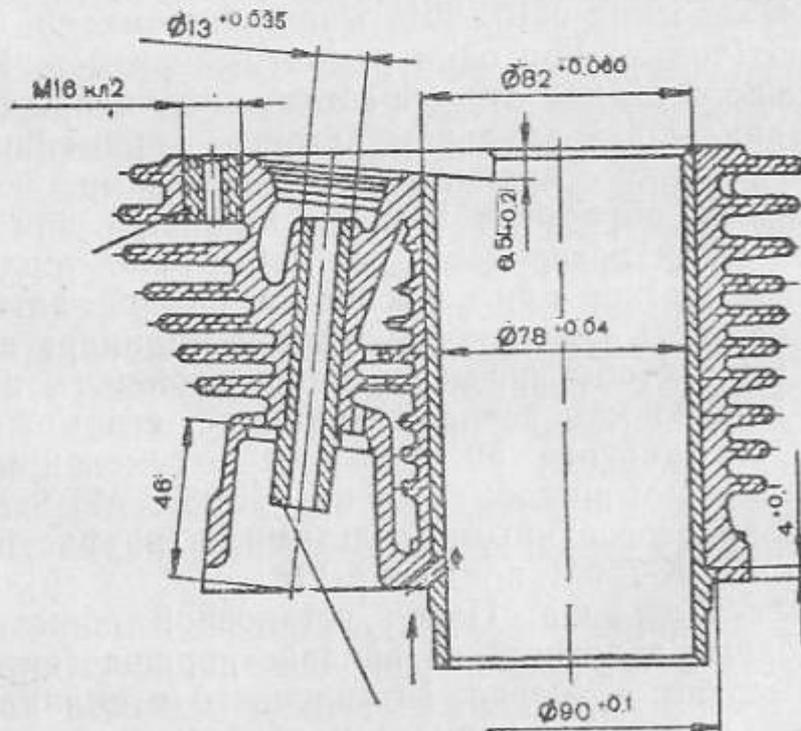
Р и с. 41. Отремонтированный цилиндр мотоциклов К-750М
