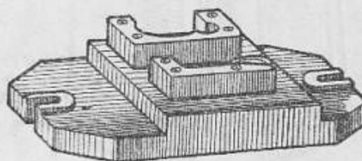
55. Приспособление для монтажа валов в коробку передач
