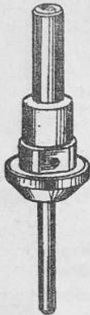
50. Набор шарошек с оправкой для обработки седла клапана
