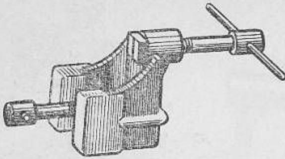
35. Приспособление для правки шатуна при изгибе стержня
