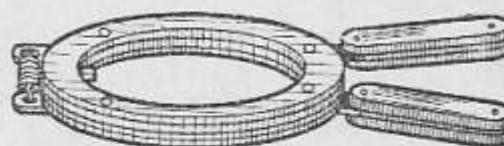
6. Приспособление для снятия и установки поршневых колец
