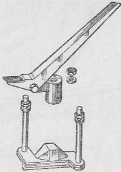
39. Приспособление для снятия пружин клапана
