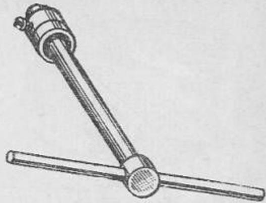
49. Приспособление для вращения клапана при его притирке
