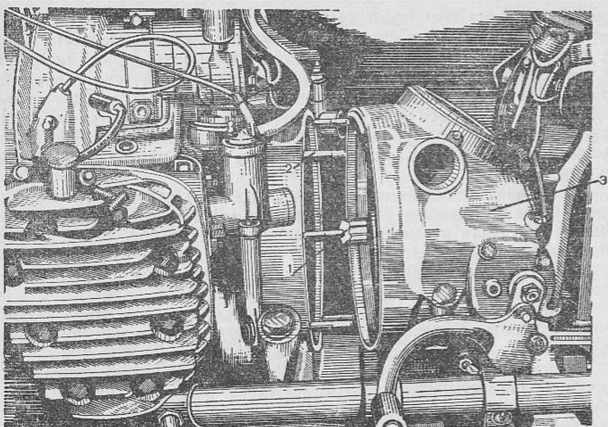
Рис. 13. Снятие и установка коробки передач:
