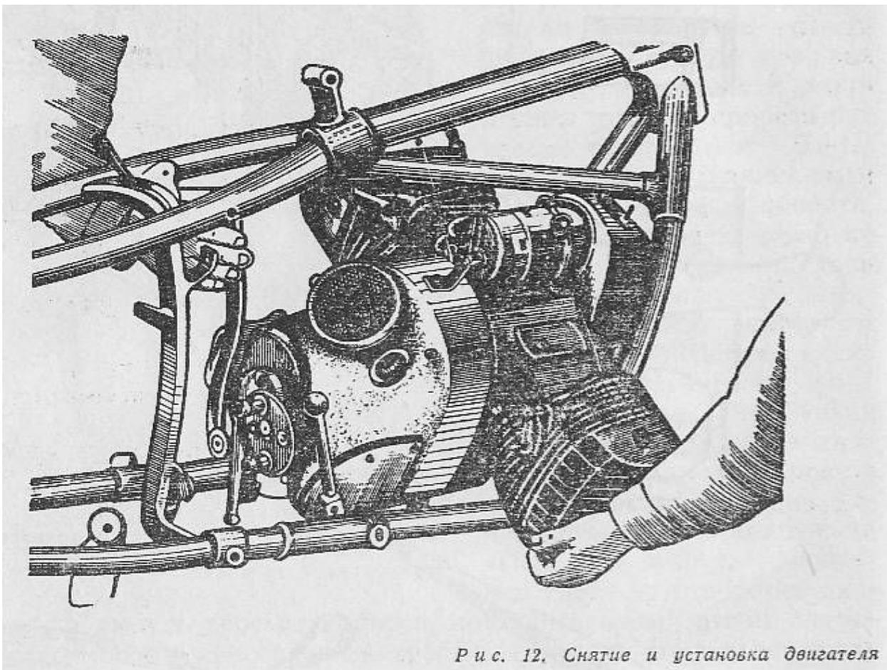
Отворачивают гайки шпилек нижнего крепления двигателя, снимают пружину рычага заднего тормоза. Подводят подставку под поддон двигателя и вынимают шпильки нижнего крепления двигателя. Сдвигают двигатель с коробкой передач вперед (рис. 12) до выхода из соединения диска упругого шарнира с резиновой муфтой или с карданным валом.
