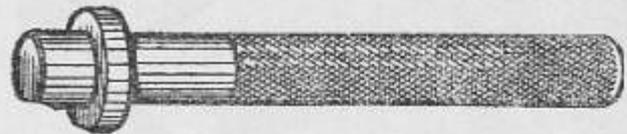
21. Оправка для снятия подшипника из переднего корпуса
