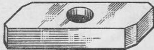
31. Подкладка для выпрессовки пальца из щеки коленчатого вала
