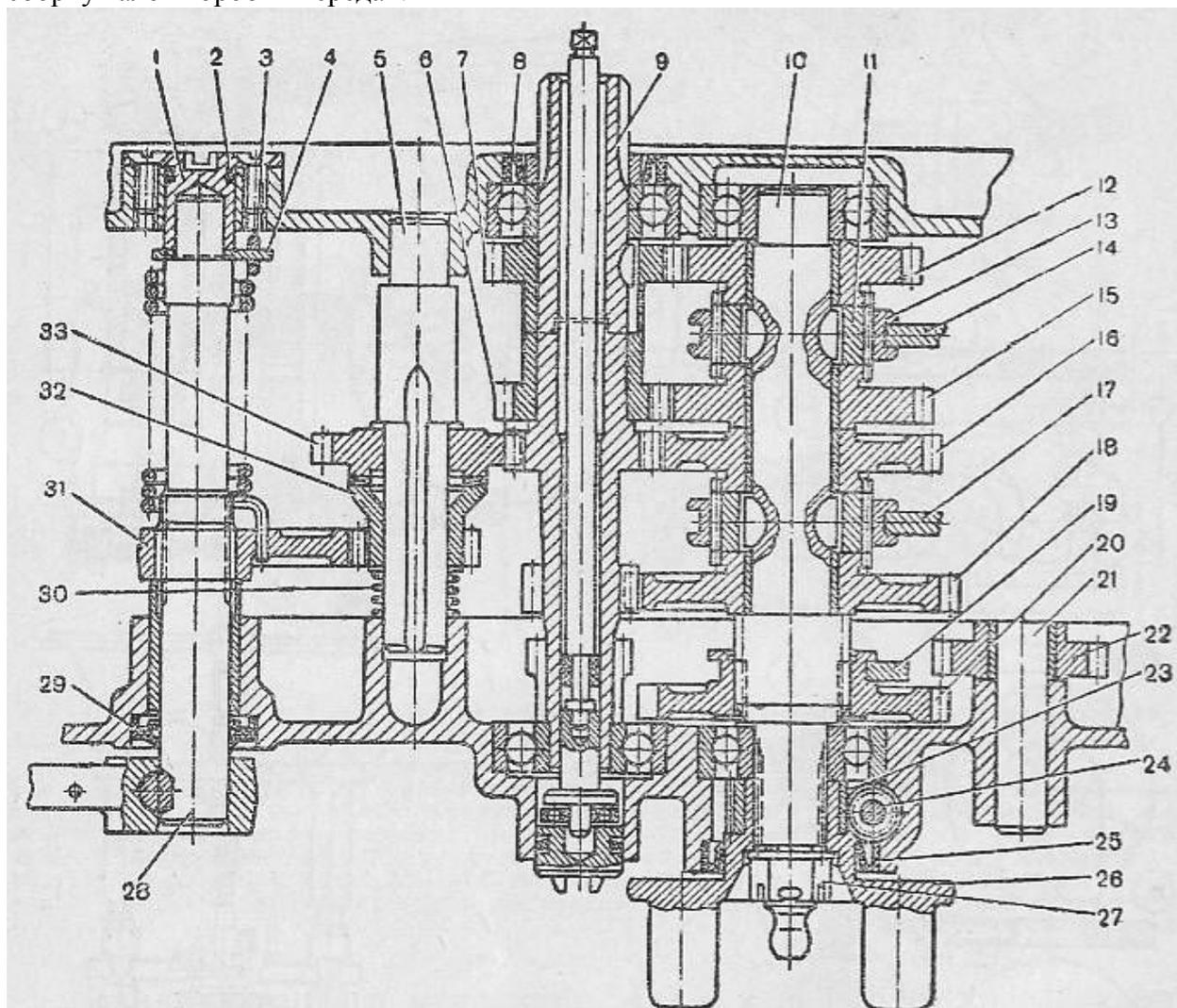
Рис. 52. Разрез коробки передач (с разверткой валов) мотоциклов «Днепр»:
