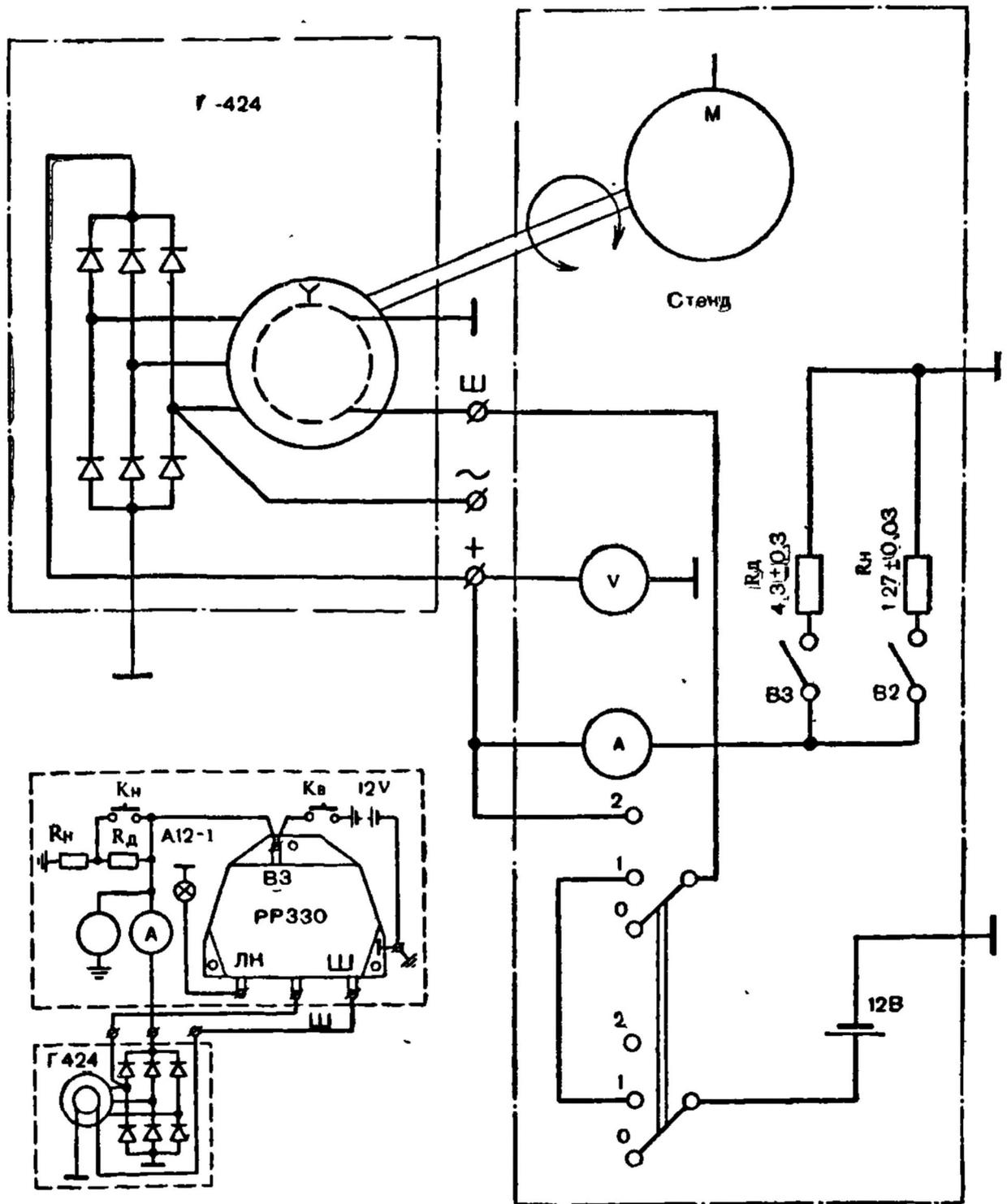
Рис. 68. Электрическая схема генератора Г-424 и реле-регулятора РР-330;  $R_d$  — 5,73 Ом;  $R_n$  — 1,27 Ом; А12-1 — лампа; Кн — кнопка нагрузки; Кв — кнопка включения аккумуляторной батареи; справа представлена схема проверки генератора на стенде
