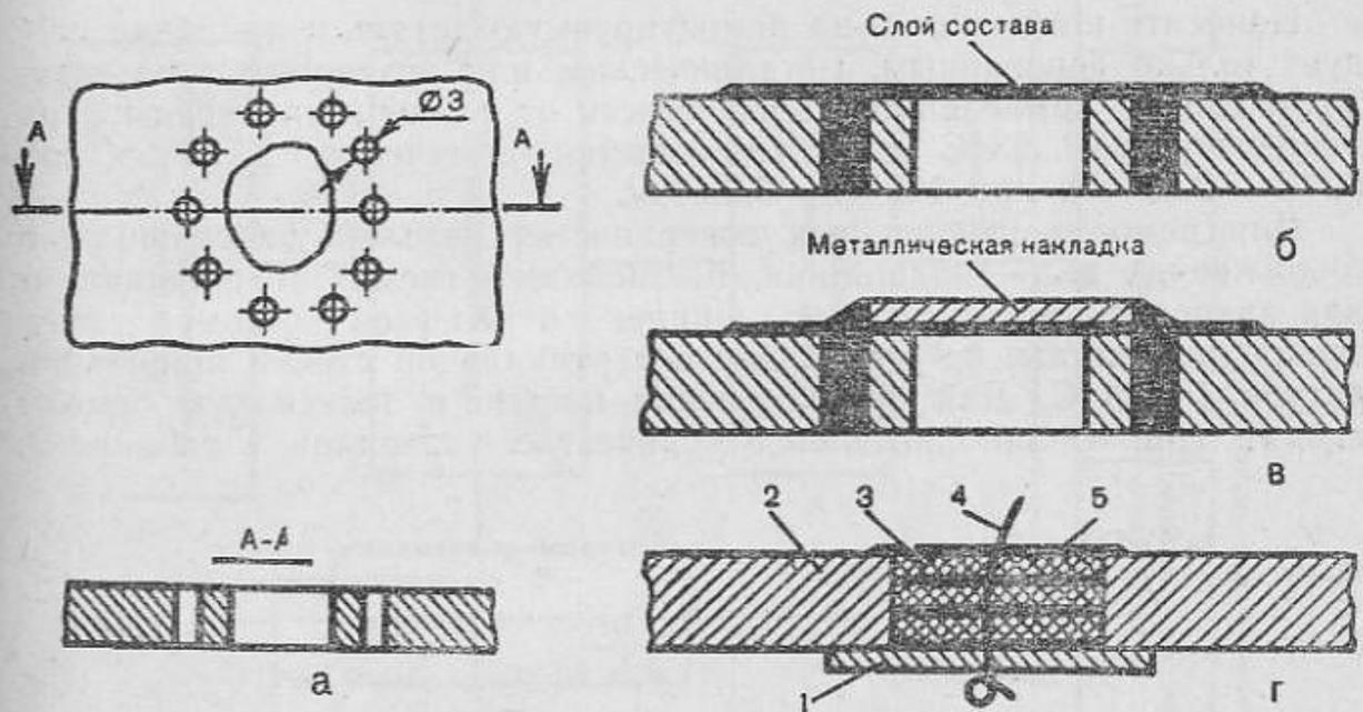
Рис. 2. Схема заделки эпоксидной композицией пробойн:
