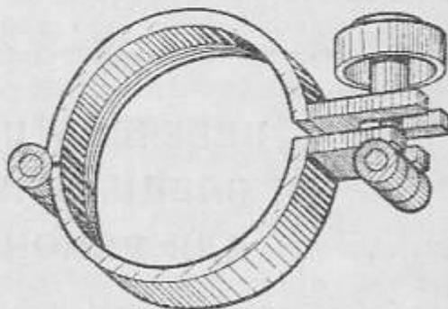
4. Приспособление для сжатия колец при установке цилиндра
