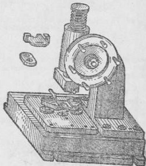
38. Приспособление для сборки коленчатого вала
