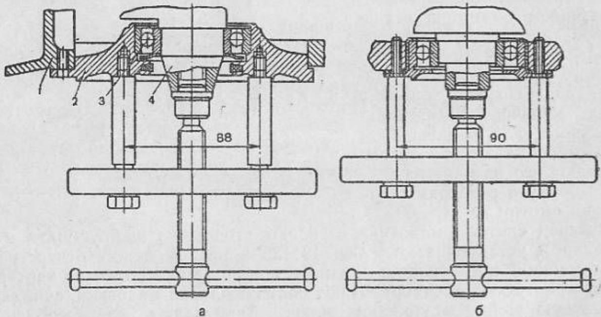
Рис. 33. Выпрессовка кривошипного механизма или коленчатого вала универсальным съемником:
