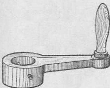
54. Рукоятка для проворачивания ведущего вала коробки передач
