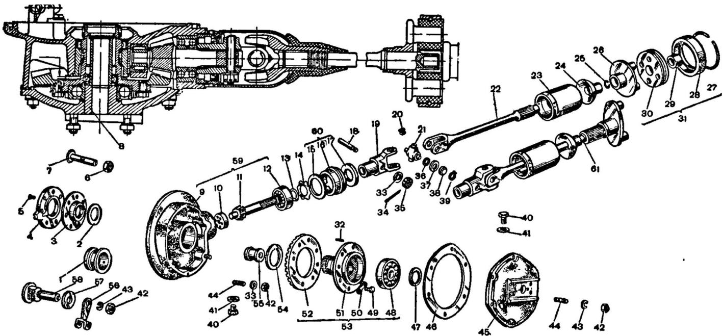
Рис. 58. Карданная и главная передача (разрез и детали);
