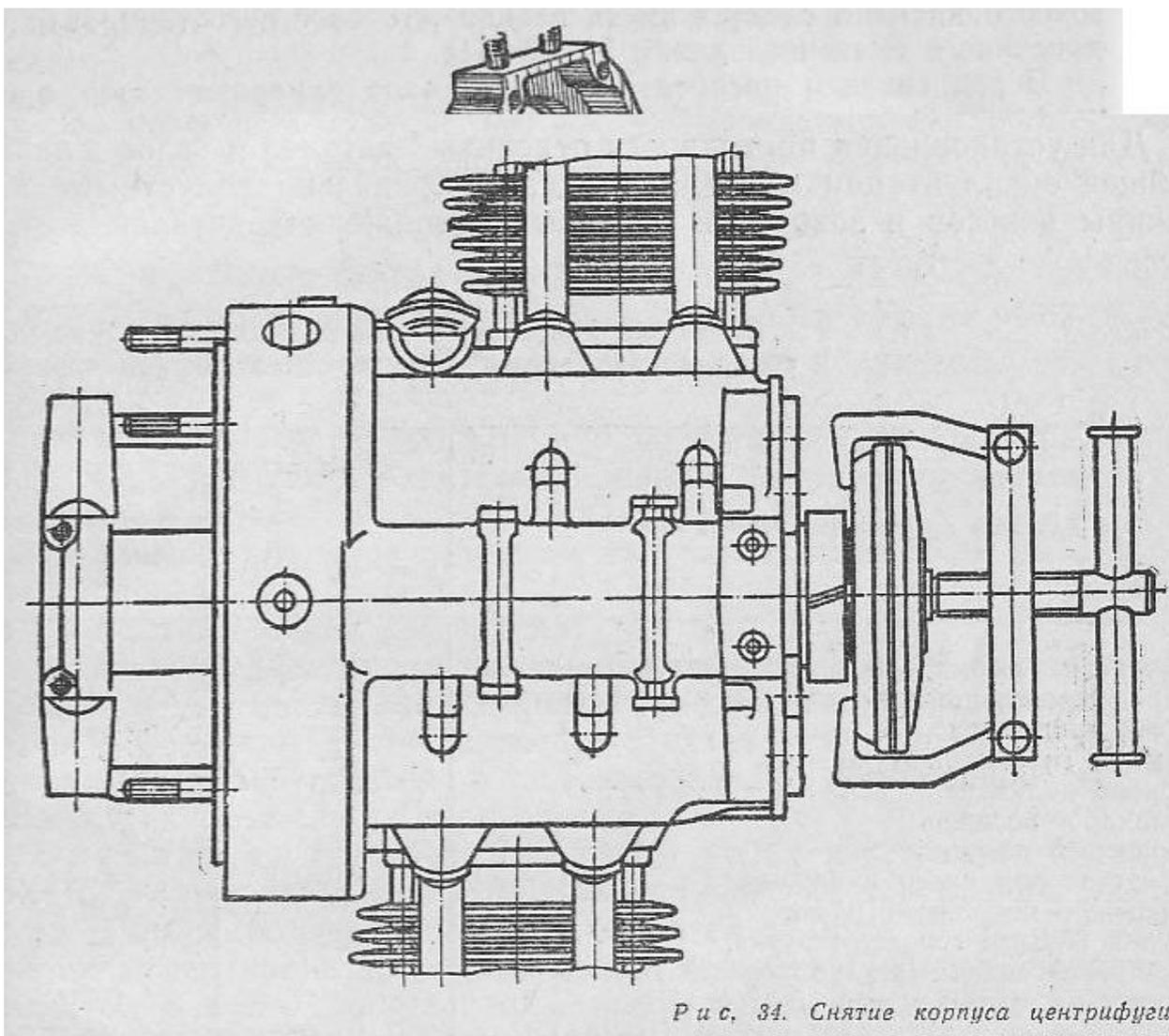
У двигателей мотоциклов «Днепр» К-650, МТ-9 и МТ-10-36 отворачивают болт крепления центрифуги, снимают шайбу, а также бумажную и резиновую прокладки, а в отверстие торца коленчатого вала заворачивают наконечник-пробку. Снимают универсальным съемником корпус центрифуги с крышкой (рис. 34). Отсоединяют крышку от корпуса центрифуги и вынимают экран. Остальные операции аналогичны.
