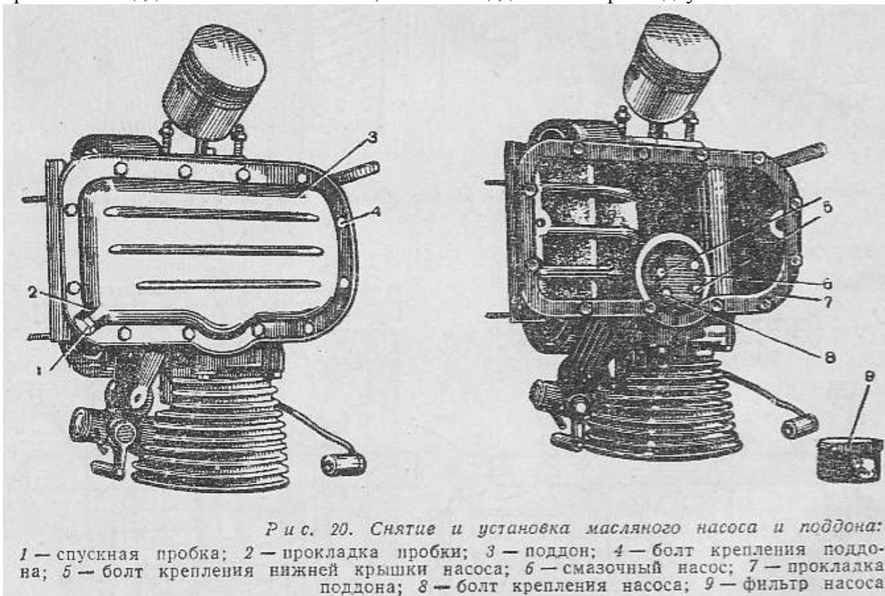
У мотоциклов серии «Урал», К-750М и «Днепр-12» следует расконтрить проволоку, соединяющую головки болтов крепления нижней крышки масляного насоса, и снять фильтр. Отворачивают болты крепления масляного насоса, снимают шайбы и масляный насос. Отворачивают пробку, снимают шестерню привода масляного насоса и вынимают соединительную штангу ведущей шестерни (рис. 20).
