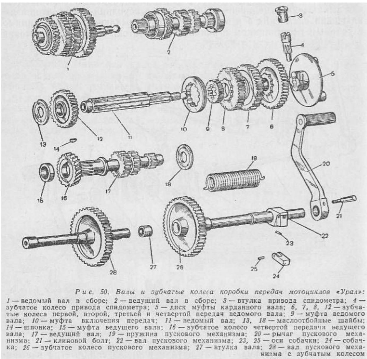
Детали пускового механизма, вали и зубчатые колеса коробки передач показаны на рисунке 50. Для снятия рычага 20 пускового механизма отворачивают гайку, снимают шайбу и выбивают клиновой болт. Отворачивают пробку буфера вала пускового механизма и вынимают пружину, а затем штифт буфера (на рис. не показано).
