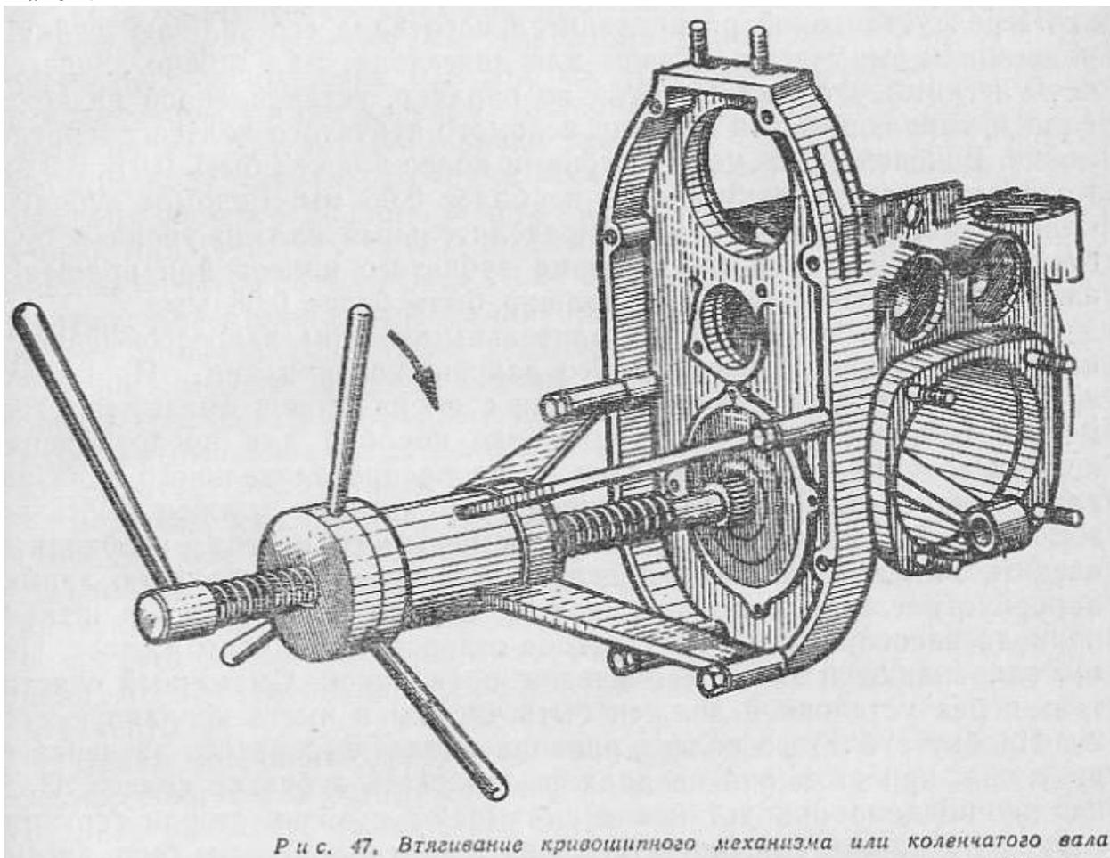
Р и с. 47. Втягивание кривошипного механизма или коленчатого вала
