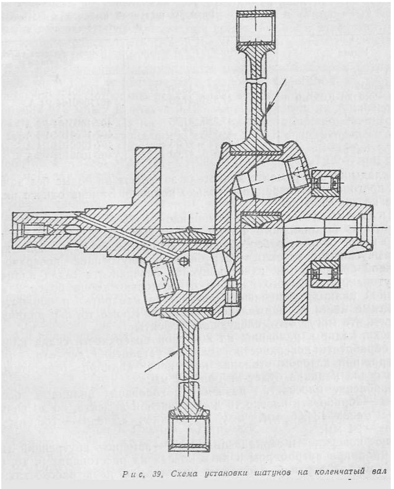
Шатуны на коленчатый вал устанавливают выступами на стержнях шатунов (указаны стрелками на рис. 39), направленными у первого шатуна вперед и у второго — к маховику. Поверхность вкладышей считается удовлетворительной, если на ней нет задиров, выкрашиваний и вдавленных инородных материалов. Темная окраска поверхности не является браковочным признаком.
