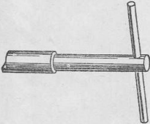
10. Оправка для снятия распределительного вала из картера двигателя
