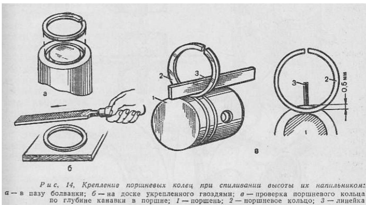
Перед установкой новых колец их подгоняют по канавке поршня вручную, припиливая личным напильником (рис. 14) и обрабатывая наждачной шкуркой, затем проверяют зазор в замке. Зазор измеряют у кольца, вставленного в цилиндр без перекосов. Выравнивать расположение кольца в цилиндре удобно поршнем, вводимым вслед за кольцом. Для компрессионных колец зазор должен быть 0,04...0,08 мм (только для новых), для маслосъемных- 0,025...0,065 мм.
