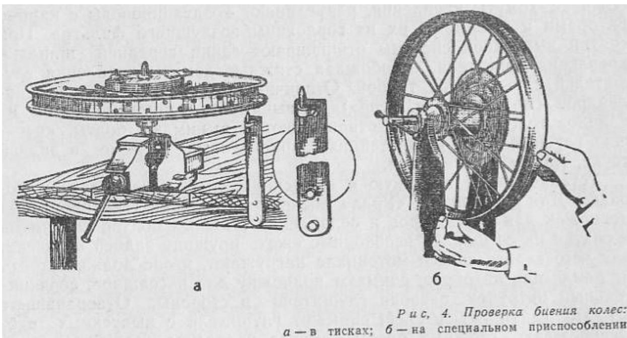
Биение колеса устраняют натяжением спиц. После окончательного устранения биения обода все спицы должны быть равномерно натянуты. Равномерность натяжения определяют на ощупь и по звуку их от отвертки, проведенной посередине спиц. После этого, положив обод на две опоры, наступают на ступицу обеими ногами (с двух сторон ступицы), а затем вновь проверяют биение и при необходимости дополнительно регулируют натяжение спиц.
