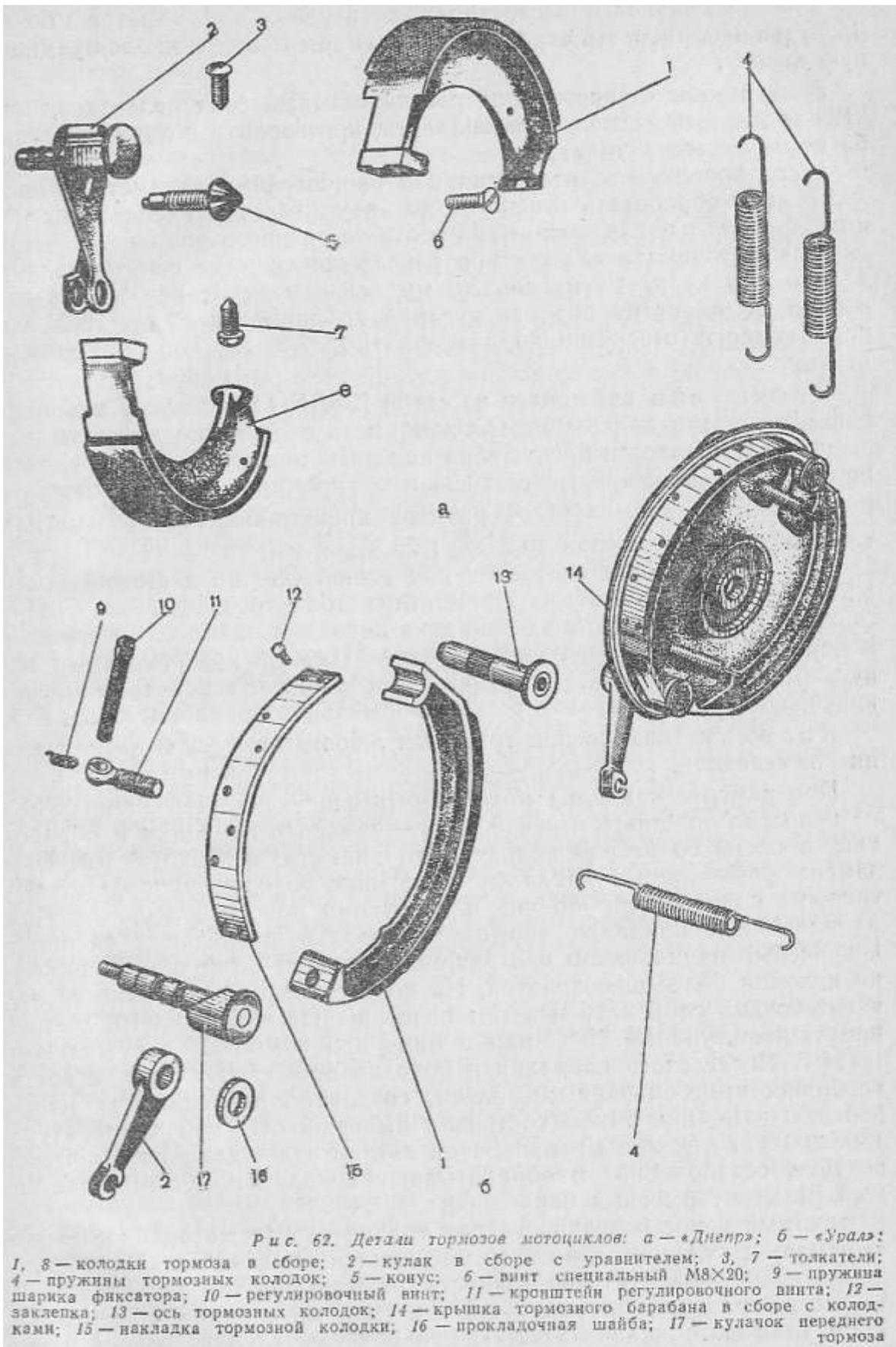
Во время осмотра деталей тормоза (рис. 62) проверяют упругость пружин колодок 4, величину износа или замасливания фрикционных накладок. Замасленные накладки промывают в чистом бензине и слегка шлифуют наждачной шкуркой, изношенные
