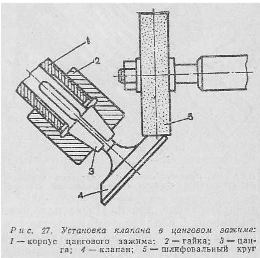
В первом случае клапан достаточно притереть, а во втором - перед притиркой рабочую фаску протачивают на токарном станке или шлифуют на круглошлифовальном станке (рис. 27), а седло клапана обрабатывают коническими шарошками.
