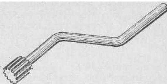
2. Рукоятка для проворачивания коленчатого вала собранного двигателя
