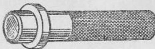
64. Оправка для выпрессовки подшипника ведомого вала из картера коробки передач и передней крышки
