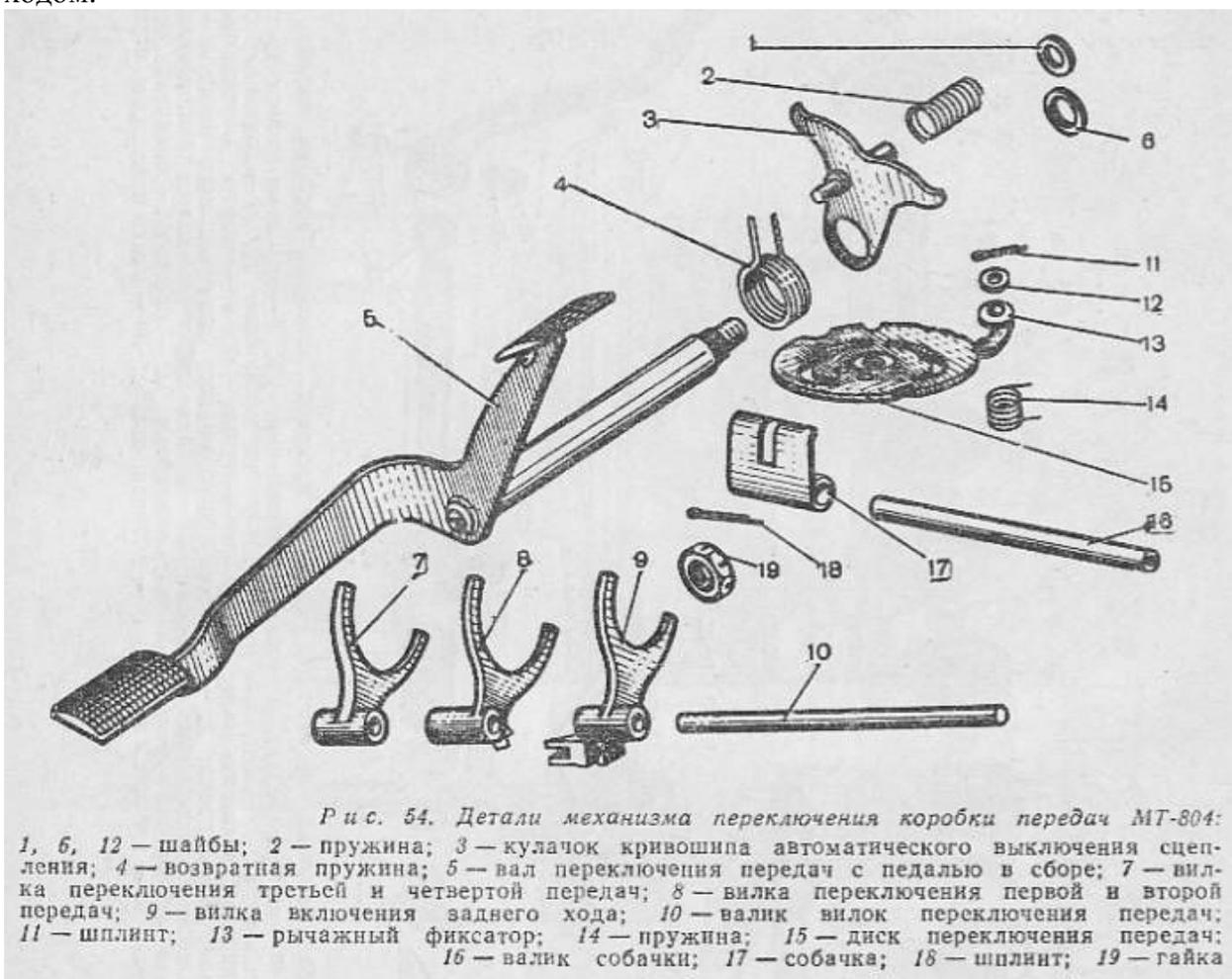
Для снятия с картера вала переключения передач 5 (см. рис. 54) вынимают валик собачки 16, собачку 17 и пружину 14, расшплинтовывают и отворачивают гайку 19 крепления кулачка кривошипа 3 и снимают его со шлицев вала переключения.
