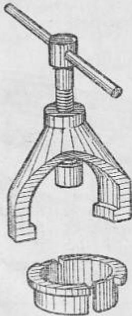
20. Съёмник подшипника с задней цапфы коленчатого вала
