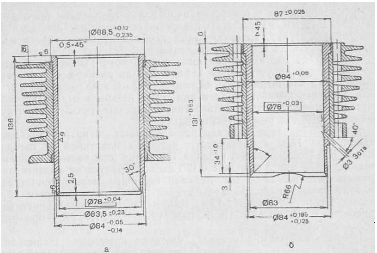
Р и с. 40. Отремонтированные цилиндры мотоциклов:
