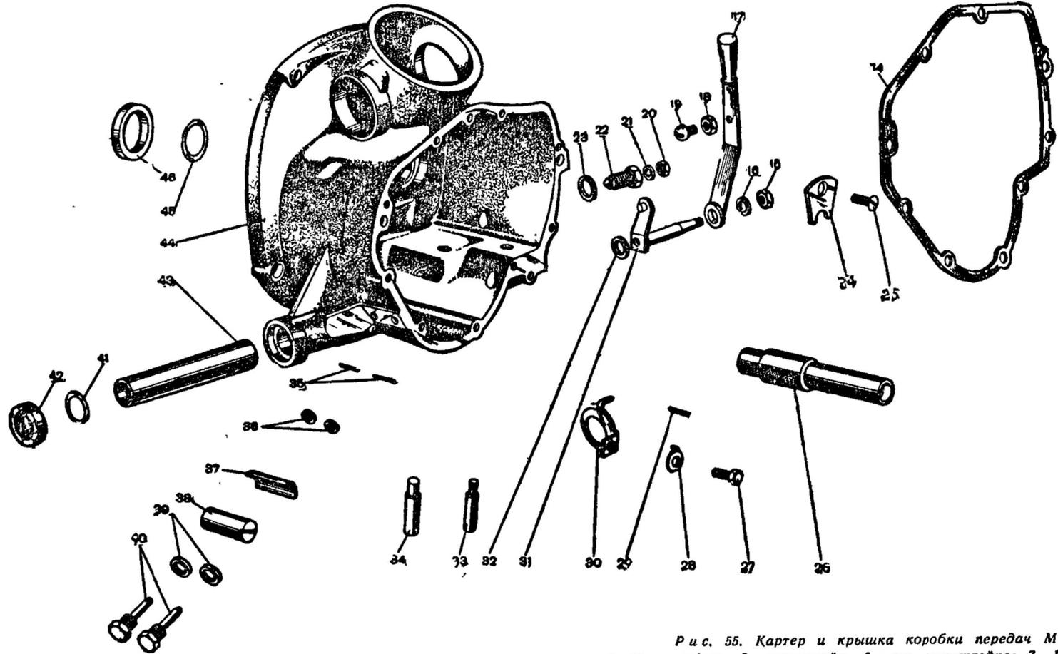
Рис. 55. Картер и крышка коробки передач МТ-804:
