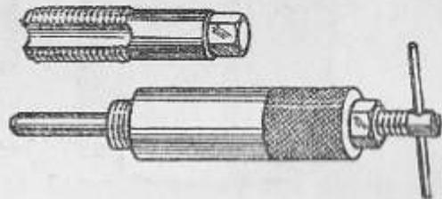
47. Съёмник с метчиком для демонтажа седла клапана
