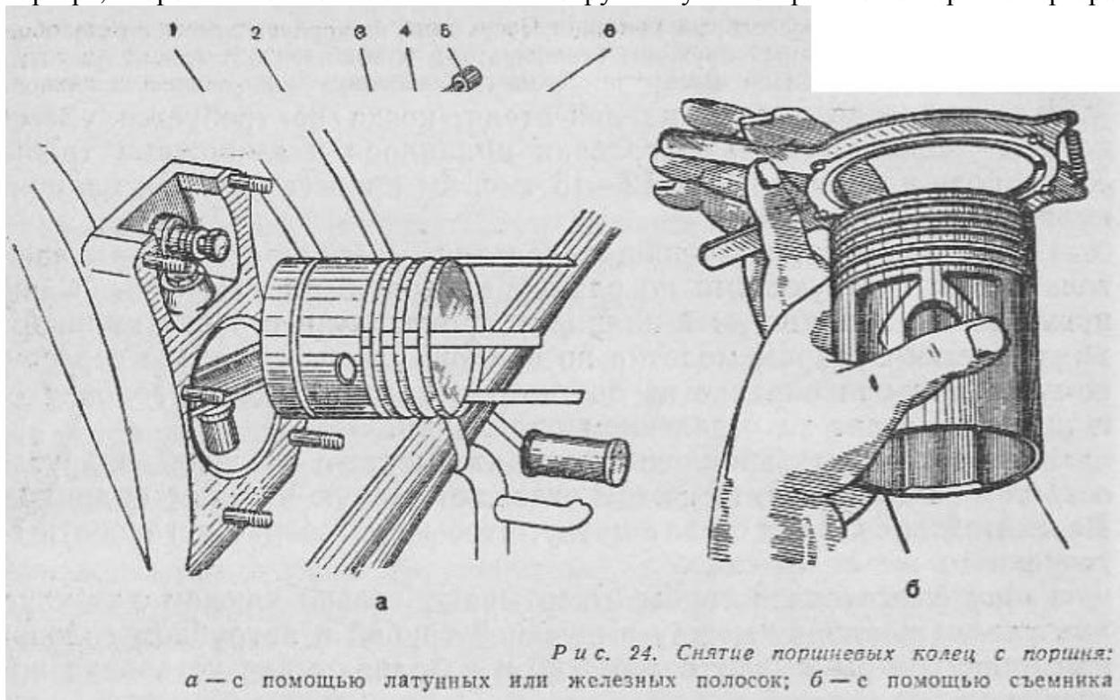
Поршневые кольца снимают с поршня съемником или латунными или железными полосками (рис. 24). При этом следует отметить месторасположение колец по канавкам поршня, чтобы при сборке установить их на свои места.
