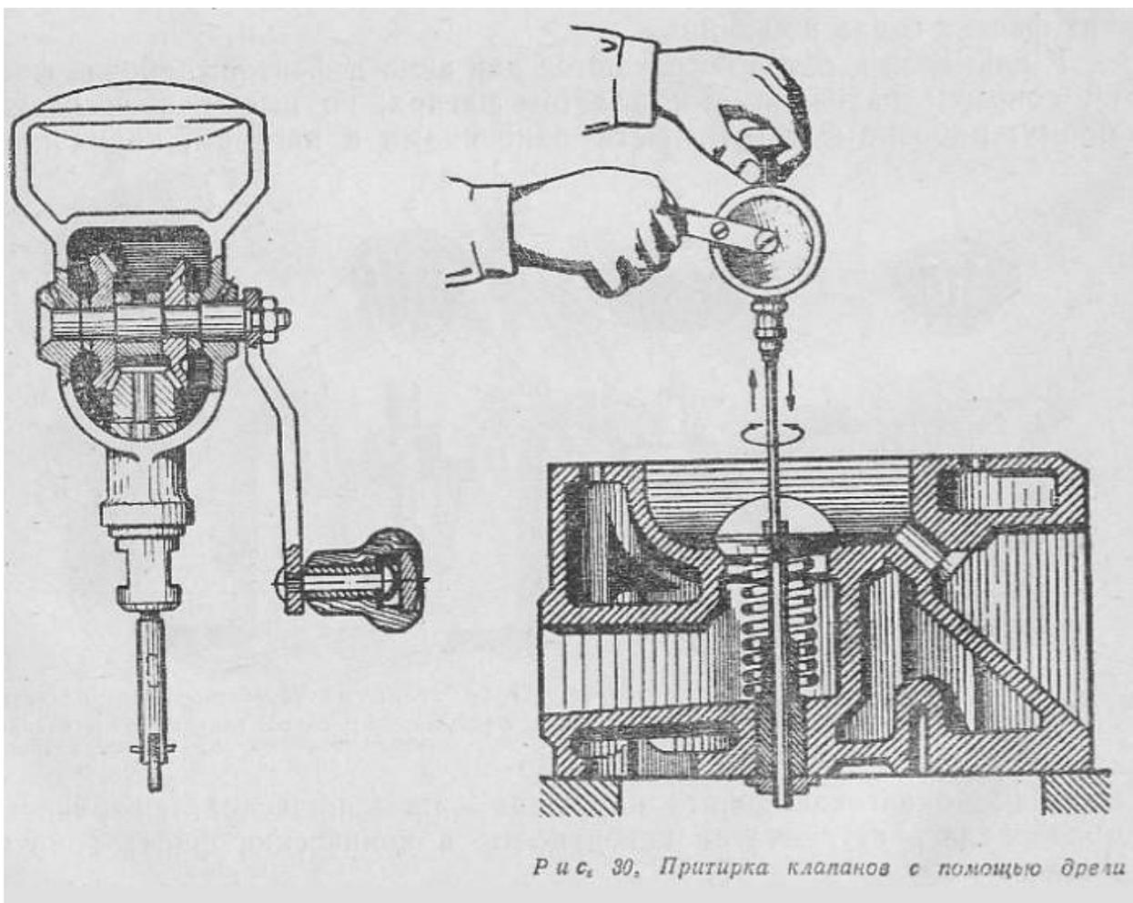
Рис. 30. Притирка клапанов с помощью дрели
