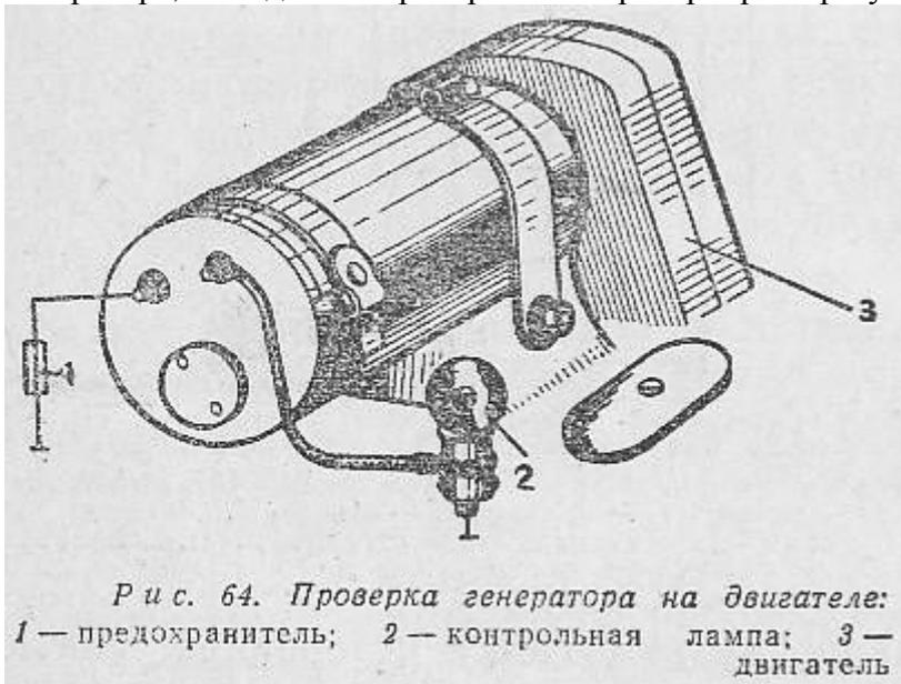
При проверке от клемм генератора отсоединяют провода. Затем клемму «Ш» соединяют через предохранитель 1 с «массой» (рис. 64), а к клемме «Я» подключают контрольную лампу 2 большой мощности. Если лампа не загорается при большой частоте вращения якоря, то это означает, что генератор неисправен. В этом случае его неисправность не связана ни с работой реле, ни с работой регулятора. Если лампа загорается, то, следовательно, неисправен реле-регулятор или провода, соединяющие его с генератором.
