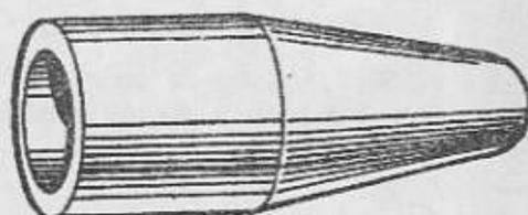
72. Наконечник для монтажа сальника амортизатора на шток
