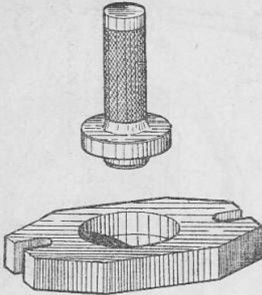
23. Приспособление для установки подшипника в передний корпус
