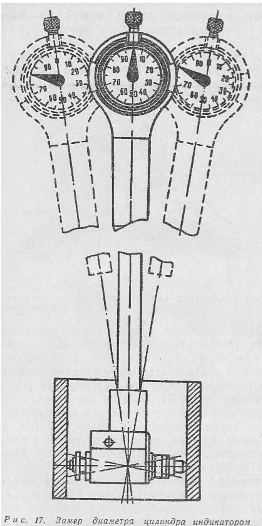
Р и с. 17. Замер диаметра цилиндра индикатором
