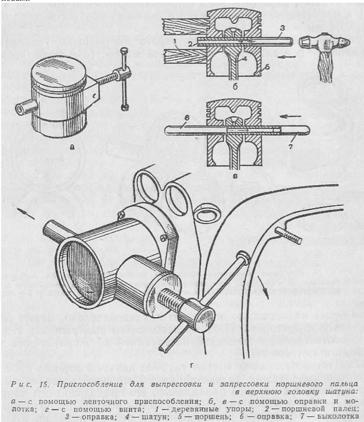
Для замены поршня применяют приспособления, указанные на рисунке 15. При снятии поршня сначала снимают стопорные кольца поршневого пальца, а затем на поршень надевают приспособление и устанавливают его на шпильки крепления цилиндра и выпрессовывают поршневой палец; при этом внимательно следят за тем, чтобы винт приспособления не портил поверхность отверстия в поршне.
