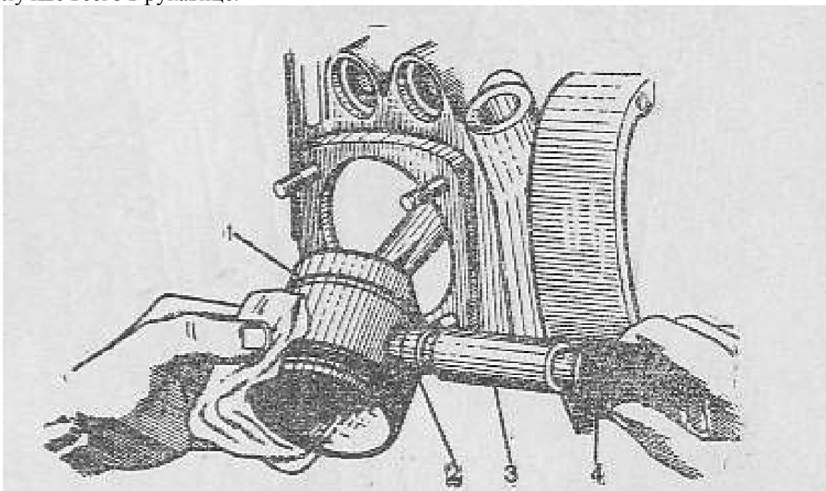
*Р и с. 16. Установка поршневого пальца в поршень и головку шатуна:
