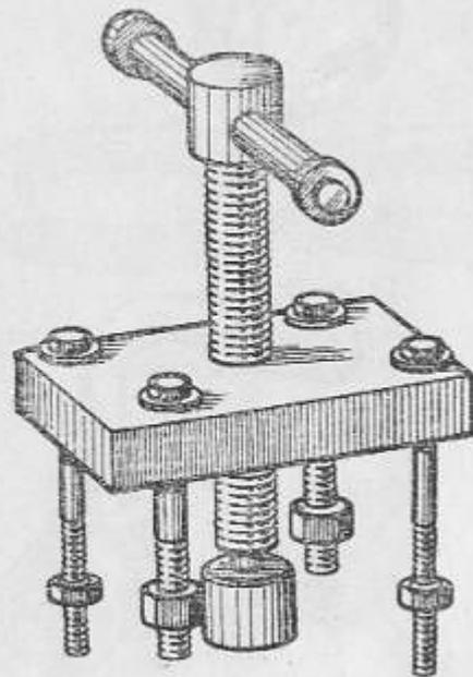
17. Приспособление для съема маховика корпуса заднего подшипника
