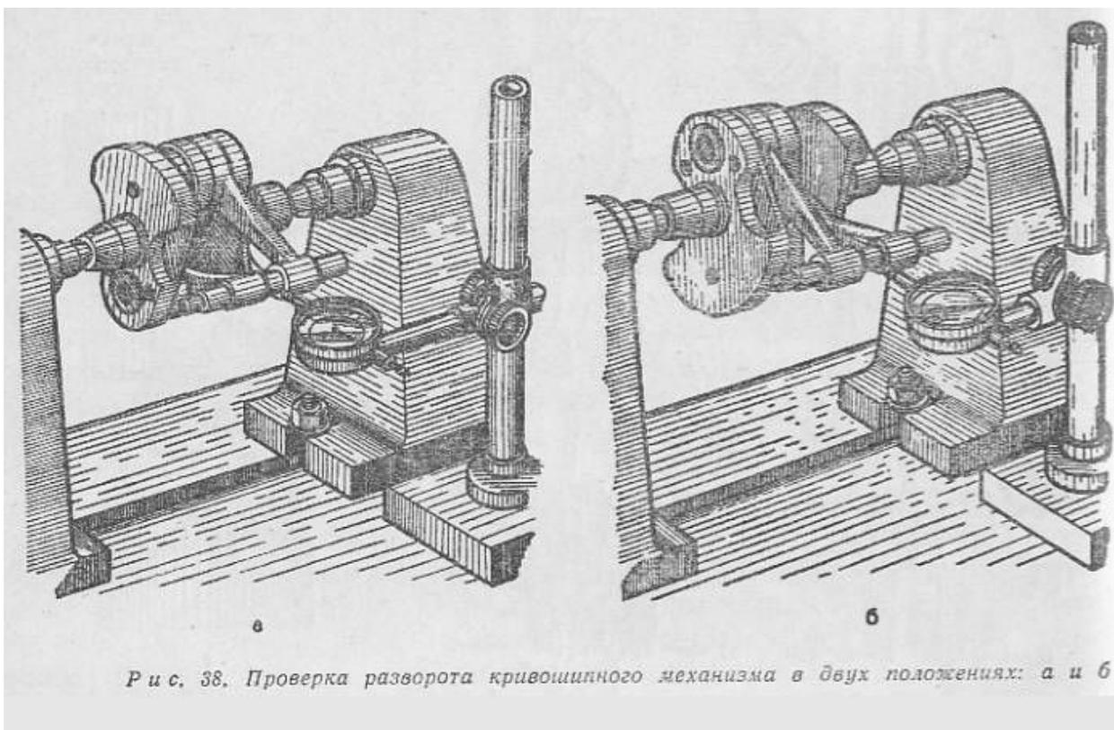
Р и с. 38. Проверка разворота кривошипного механизма в двух положениях: а и б
