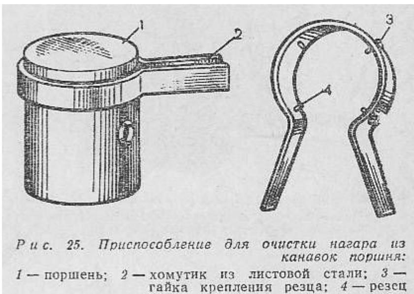
Нагар очищают из всех уголков канавок поршня специальным приспособлением (рис. 25), состоящим из стальной ленты, на внутренней поверхности которой закреплены резцы. Приспособление устанавливают в канавку поршня, сжимают рукоятки и, поворачивая его кругом, удаляют нагар. Поршень при этом должен быть закреплен в тисках с губками, имеющими свинцовые или медные прокладки.
